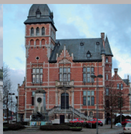
Brasschaat, Gemeentehuis: geveldelen in blauwe hardsteen en metselwerk met Anti-Graffiti coating 'PSS 20'® tegen graffiti beschermd
